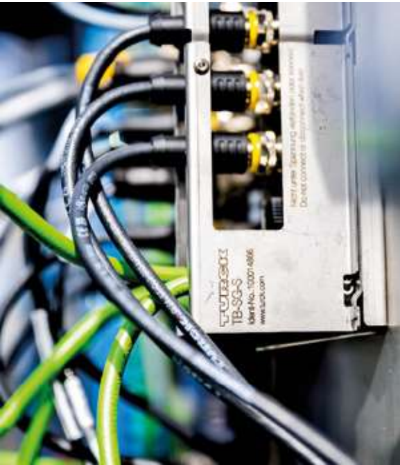
因为采用TB-SG不锈钢保护外壳，所以几乎所有TBEN I/O模块都获批用于ATEX 2区
