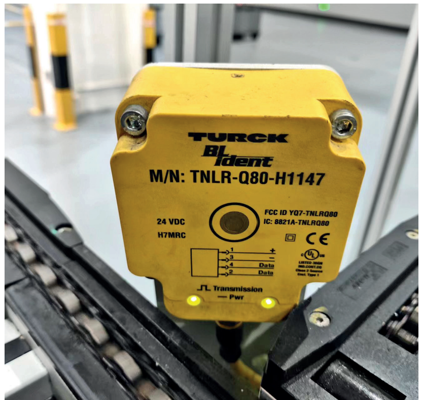
得益于更大的检测范围，图尔克坚固可靠的Q80高频读写头即使在载码体位置有所偏差时也能实现可靠的RFID检测
