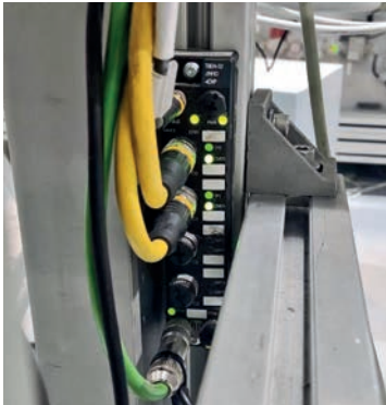
图尔克的紧凑型TBEN-S2 RFID接口确保了快速可靠的数据传输
