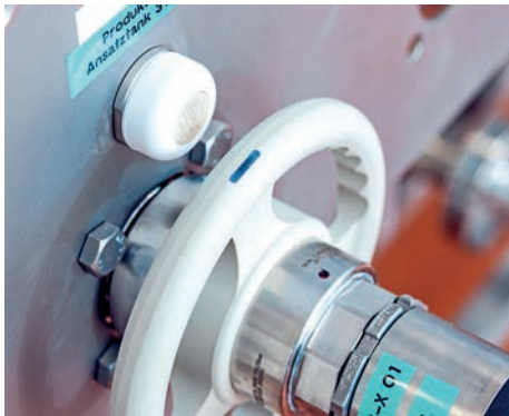
一旦连接软管，RFID系统就会验证连接
