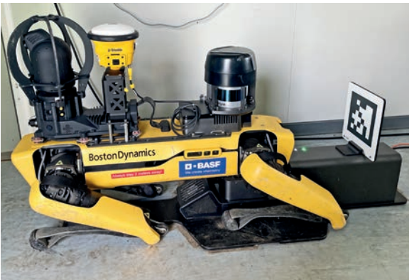
一旦机器人停靠到位，TBEN-S RFID接口就会自动关闭充电区域的门
