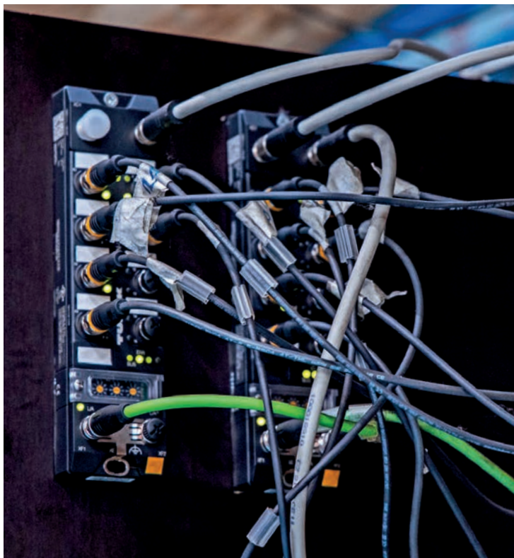
紧凑的TBEN-LL-16DXP block I/O模块将传感器数据结合在一起，并将其实时发送出去
