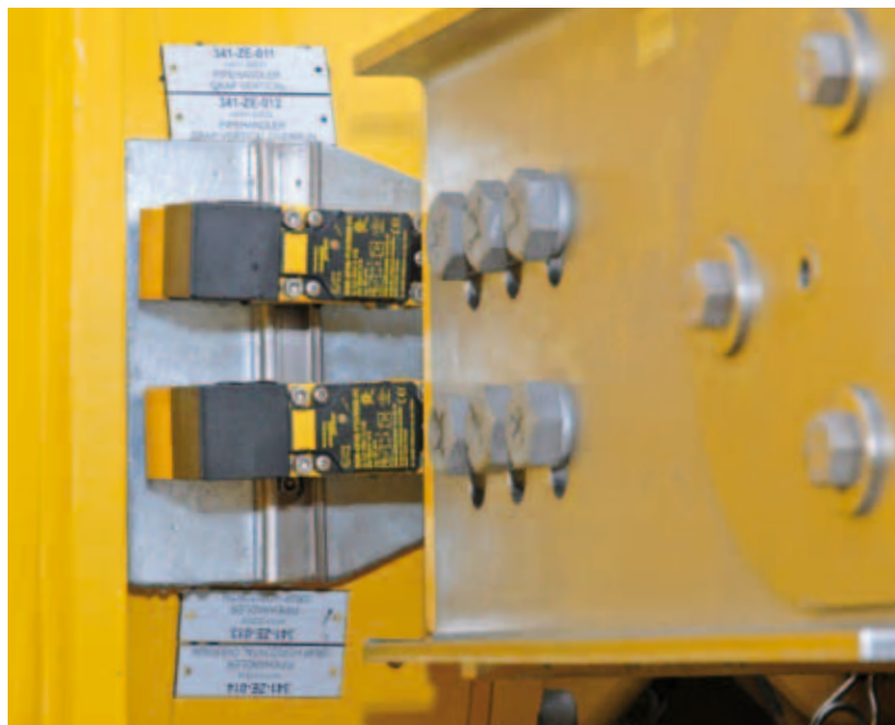
为了能够使两个电感式传感器可以近距离安装使用，图尔克研发了一款带可变频率振荡器的传感器。
