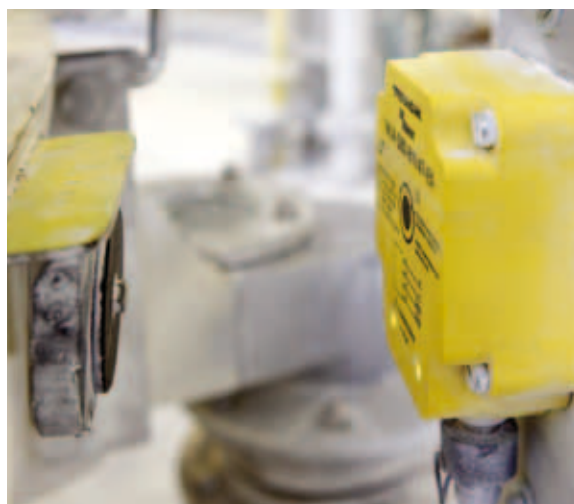
一个Ex读写头从筛子（左侧）上的标签中读取筛格宽度
